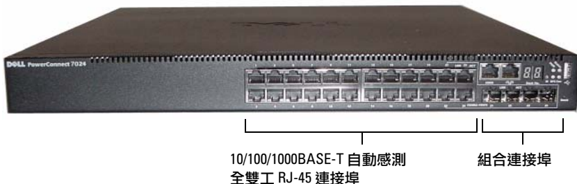
圖 1-1. PowerConnect 7024，具有 24 個 10/100/1000BASE-T 連接埠
